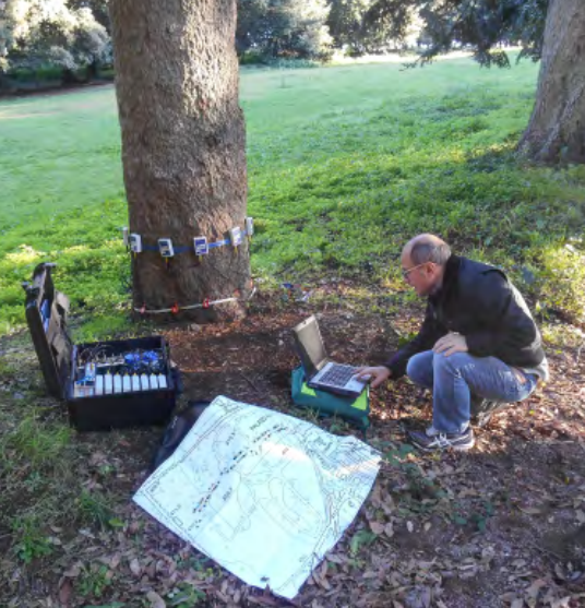
Rilievi effettuati mediante tomografo sonico su un esemplare di Abies alba . Analysis made with a sonic tomograph on an Abies alba .
